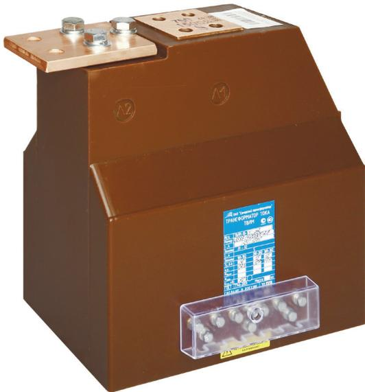
Трансформатор тока ТЛК-СТ-10-ТВЛМ (ТВЛМ-10) опорный предназначен для передачи сигнала измерительной информации измерительным приборам и устройствам защиты и управления, для изолирования цепей вторичных соединений от высокого напряжения в комплектных электрических устройствах внутренней установки (КРУ, КРУН, КСО) переменного тока на класс напряжения до 10 кВ.
